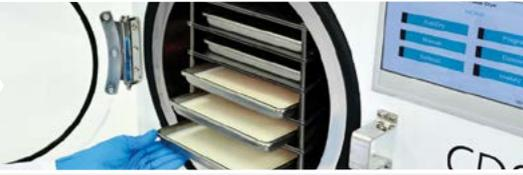
**CryoDry®** 冷冻干燥机专为批量/散装应用而设计，与传统的被动冷冻干燥机相比，具有多项优势。**Easy-Load** 功能允许方便地在抽屉式托盘中装载和卸载产品 - 在托盘、盘子、瓶子和类似产品中 - 而无需抬起沉重的丙烯酸或不锈钢歧管。此外，**CryoDry® CD8** 还提供一系列热传导块，能够对试管、样品瓶和安瓿瓶进行高效、快速冷冻干燥。
