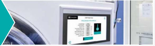
**CryoDry®** 冷冻干燥机旨在快速高效地进行冷冻干燥。它具有温控搁板，可实现快速冷冻和更快的干燥。传统被动冷冻干燥机不具备此功能。我们的可编程搁板的温度范围为 **-40°C 至 +60°C** 使冷冻干燥过程可定制。具备能量输入的加热搁板功能意味着 **CryoDry®** 冷冻干燥机可以显著缩短干燥时间，与传统的被动冷冻干燥相比，通常可节省 **60%** 以上的时间。
